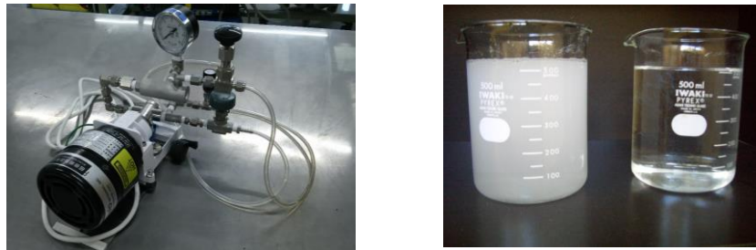
図2 マイクロバブル発生装置と純水へのマイクロバブル混入の有無
